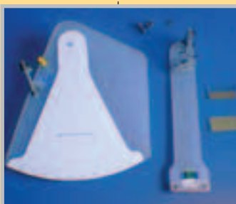
Секстант со снятым шарниром и зеркалами
