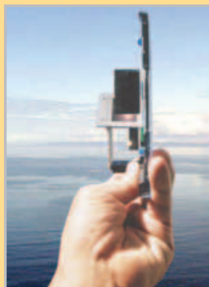
Измерение угла солнца над горизонтом с помощью CD-секстанта.
